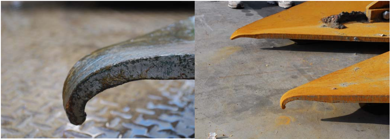
Figur 8. Eksempel på deformasjon av ankertenner som følge av møte med stein i bunnsedimentet.
